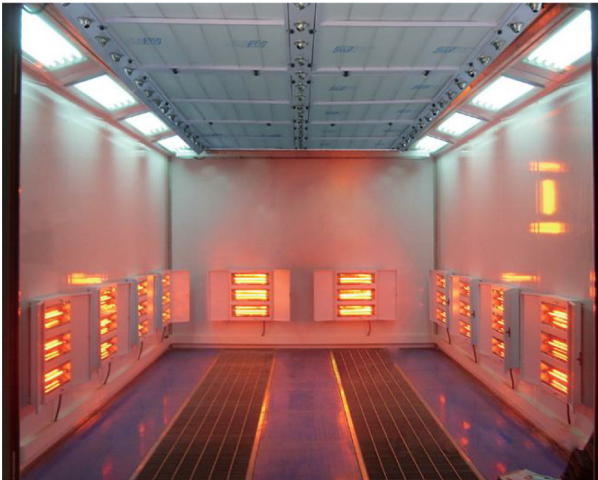
Phòng sơn gốc nước âm sàn trần cao cho các loại xe ô tô 4 - 16 chỗ
